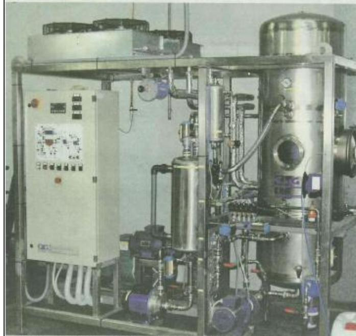
Evaporador al vacío instalado en los talleres de ABC para tratar los líquidos residuales que genera la impresión.
