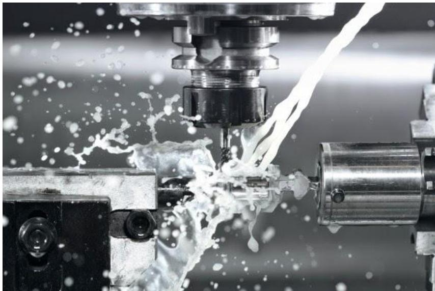
EN LOS PROCESOS DE MECANIZADO SE UTILIZAN PRODUCTOS COMO: TALADRINAS (EMULSIÓN AGUA/ACEITE), DESMOLDEANTES, AGUA DE REFRIGERACIÓN, DESENGRASES, ABRASIVOS, ETC. QUE CUANDO SE AGOTAN, SE CONVIERTEN EN RESIDUOS PELIGROSOS. TODOS ELLOS PUEDEN SER CONCENTRADOS CON UN EVAPORADOR AL VACÍO, PARA GESTIONAR EXTERNAMENTE LA MENOR CANTIDAD POSIBLE DE RESIDUO.
